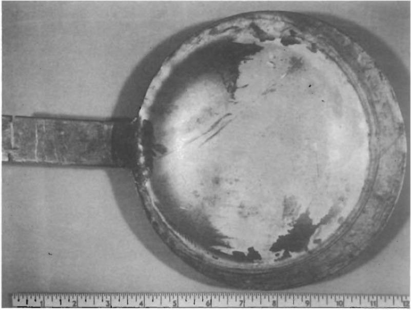
Gambar 1-6. Pelat-sisip menjadi kembang oleh tekanan gauge 32 bar (470 psi).
