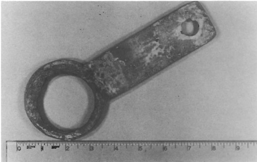
Gambar 1-5. Pelat-sisip dibiarkan di tempatnya berbulan-bulan yang berkarat hingga bolong.
